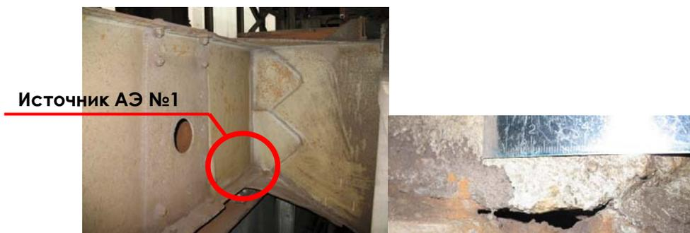
*Рис. 5. Дефект №1 в области соединения главной балки №1
