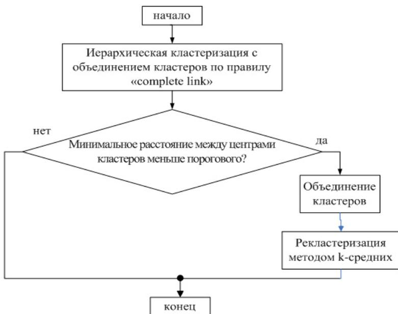
*Рис. 3. Блок-схема алгоритма кластеризации осциллограмм*
