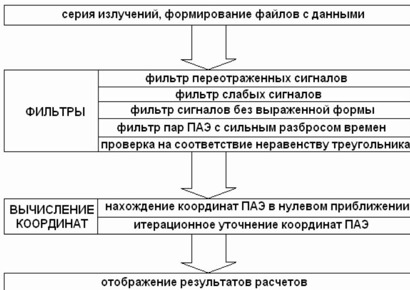
*Рис. 1. Блок-схема метода*
