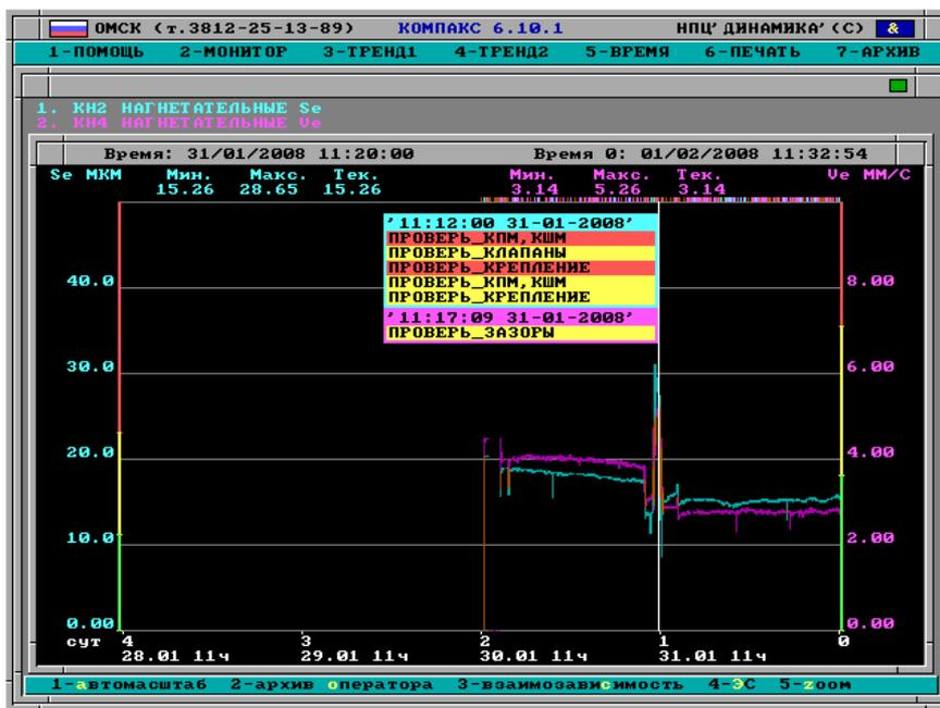
*Рис. 9. Экран «ТРЕНД» диагностических признаков с выводом сообщений экспертной системы поддержки принятия решений*
