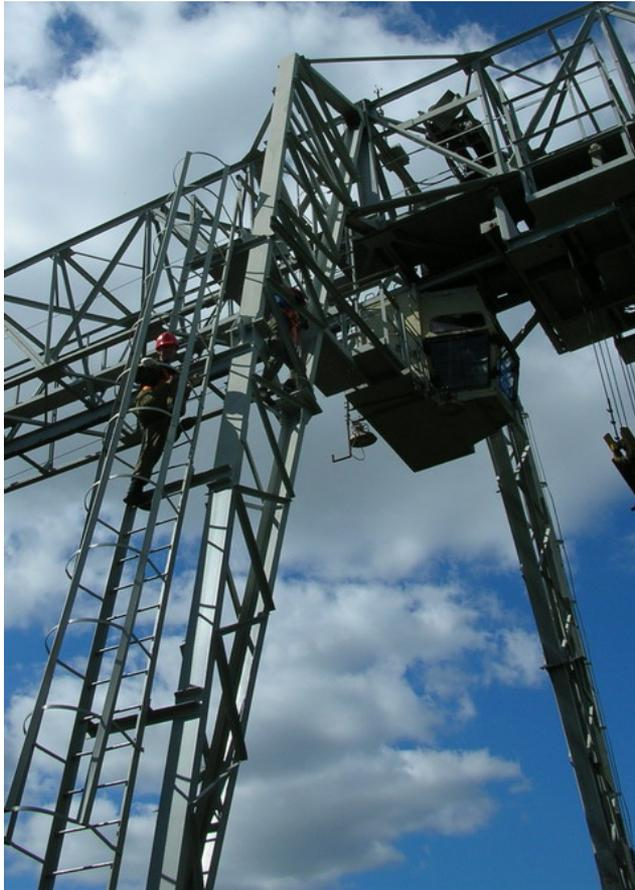
*Рис. 1. Вертикальные опоры крана ККС-10 грузоподъемностью 10 тонн*
