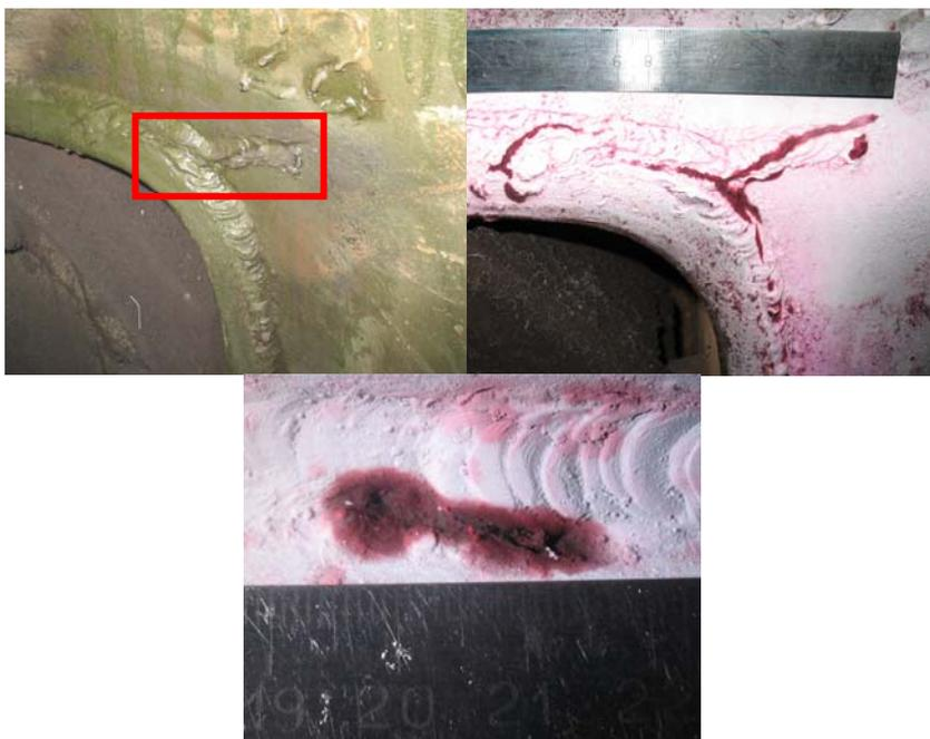
*Рис. 6. Трещина и её фрагменты по КПВ в области буксового узла,
