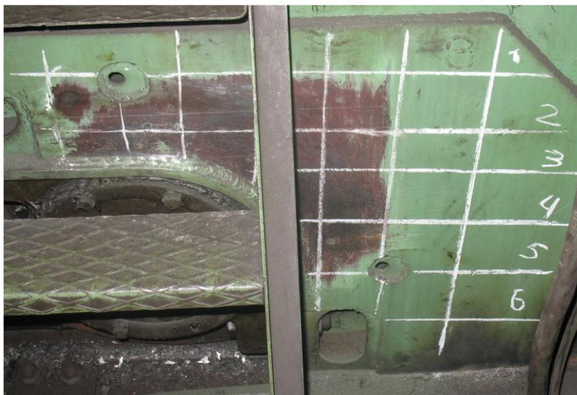
*Рис. 7. Область расположения источника АЭ №3 с нанесенной сеткой для определения собственных магнитных полей рассеяния методом ММП*
