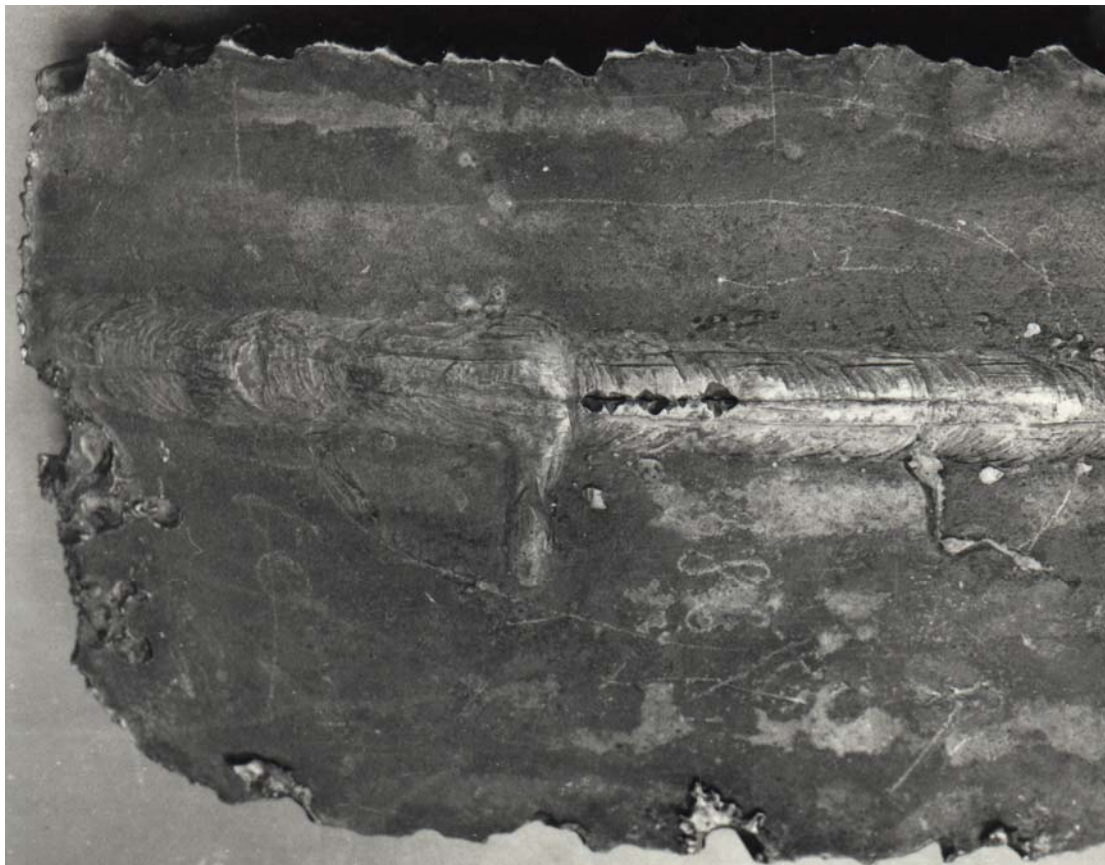
Рис. 1. Участок трубы с щелевым отверстием размером 0,1 \times 25 \text{ мм}^2
