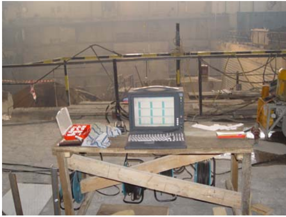
Рис. 1. Акустико-эмиссионный комплекс A-Line 32D производства ООО «Интерюнис»
