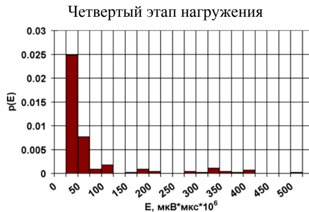
Рис. 14. Распределение энергетических параметров АЭ сигналов
