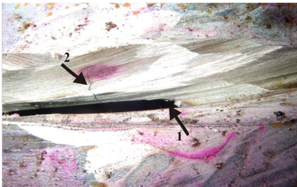
Рис. 6. Магистральная и вторичная трещина в аустенитном сварном шве линии V.201/1: 1 – выборка магистральной трещины; 2 – вторичная коррозионная трещина
