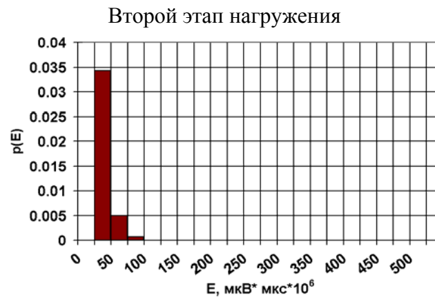
Рис. 8. Распределение энергетических параметров АЭ сигналов
