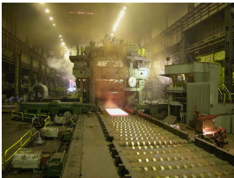
Рис. 3. Прокатный стан «5000» (ширина листа до 5000 мм)
