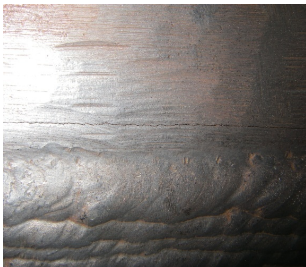
Рис. 13. Трещина в зоне кольцевого шва приварки фланца верхнего штуцера реактора риформинга (источник АЭ III класса)
