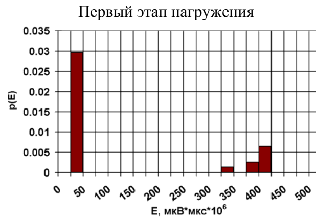
Рис. 5. Распределение энергетических параметров АЭ сигналов
