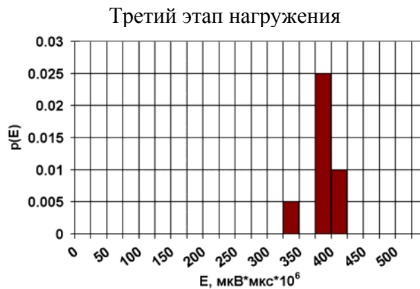
Рис. 11. Распределение энергетических параметров АЭ сигналов
