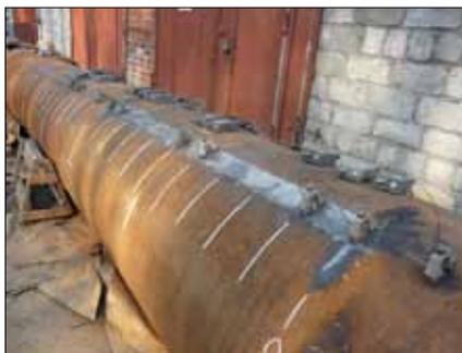
Рис. 6. Искусственный дефект размером 2000 на 60-80 мм. ПАЭ – на оси дефекта
