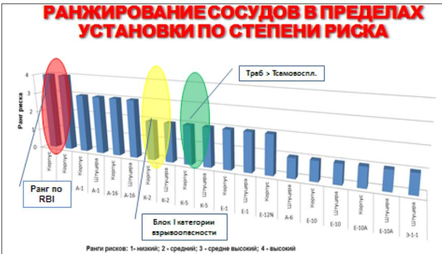
Рисунок 6 — Ранжирование по степени риска установок площадки переработки нефти
