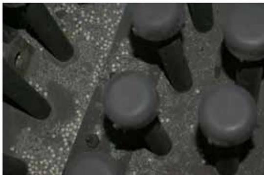
Рис. 8. Катализатор и фарфоровые шарики на поверхности тарелки (фото в процессе ремонта)
