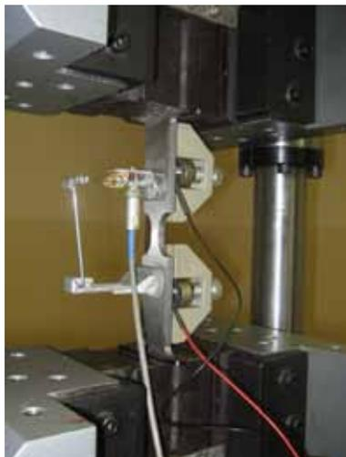
Рис. 3. Образец, зажатый захватами испытательной машины, с установленным экстензометром и преобразователями акустической эмиссии
