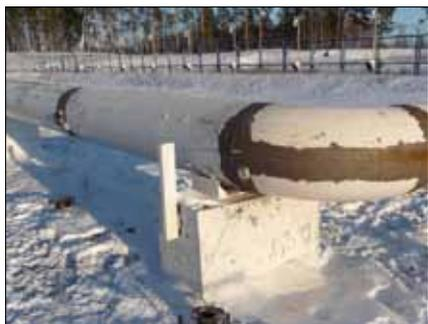
Рис. 7. Эксперимент на трубе, выходящей из камеры приема-пуска снаряда
