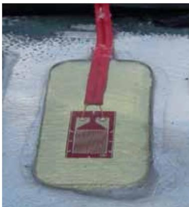
Устройство и принцип работы. Основной составляющей тензодатчика является чувствительный элемент, преобразующий деформацию твердого тела в электрический сигнал. Чувствительный элемент, имеющий выводные проводники для присоединения в сеть, помещается на упругую подложку и закрывается защитным элементом, а затем закрепляется с помощью связующего (клей, цемент) на исследуемой детали (рис. 2).
