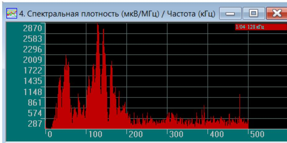
Рис. 9.6. Пример частотного спектра, полученного из осциллограммы
