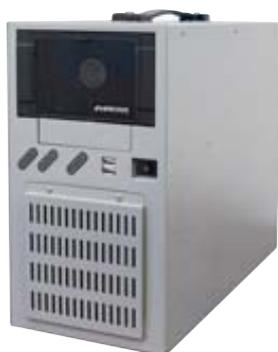
**Ethernet Box XL** – портативный АЭ комплекс сбора данных в корпусе увеличенных размеров с возможностью удаленного доступа по стандартному протоколу **Ethernet 10/100 Base-T**. Предназначен для совместного использования с любыми компьютерами (ноутбуками).
