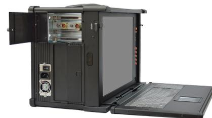
**Portable XL** – компактный переносной АЭ комплекс в индустриальном компьютере увеличенных размеров, предназначенный для измерений в полевых условиях.
