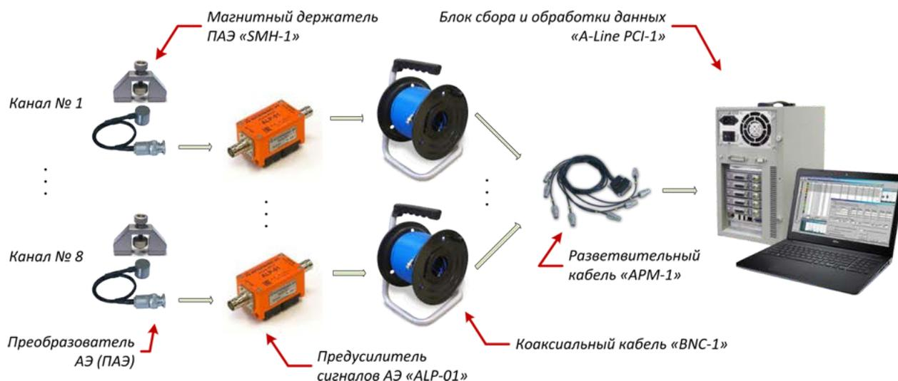
Схема АЭ комплекса **A-Line PCI-1**
