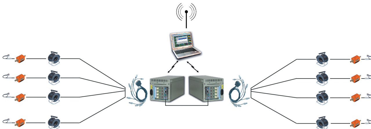
Схема АЭ комплекса A-Line PCI-1 при подключении нескольких блоков сбора и обработки данных, исполнение Ethernet Box
