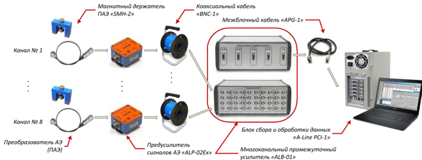
Схема АЭ комплекса A-Line PCI-1 во взрывозащищенном исполнении
